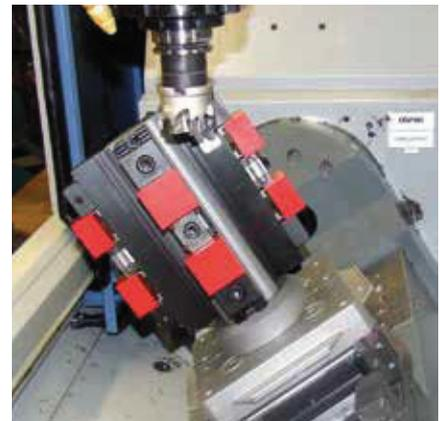
Mehrfachspannsystem MSE 260-50-1 auf Spannturm 90°
