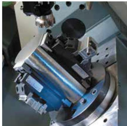
Mechanischer Zentrischspanner MZE 170-60 auf Spannturm 120°
