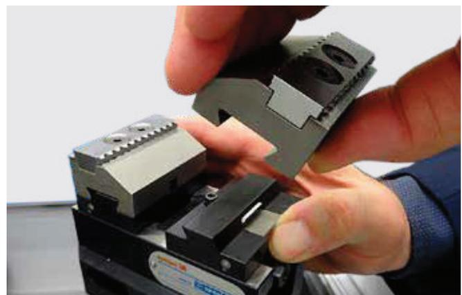
Spannbackenwechsel in Sekunden, ohne Werkzeug!
